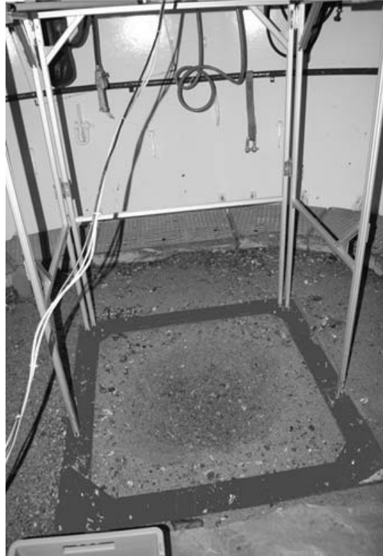
Abbildung 21: 3D Streifenprojektionsscanner (oben) und Metallrahmen mit quadratischer Kunststoffbasis zur Porositätsmessung im Taucherglockenschiff (unten) (Frings).
