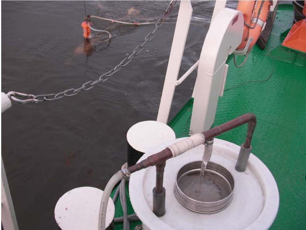
Abbildung 13: Entnahmegerät für die Schwebstoffprobe (oberer Bildrand, unter Wasser) und Filtrierung des suspendierten Sandanteils (vorn) am 5.11.2009 an der Messstelle Vockerode.
