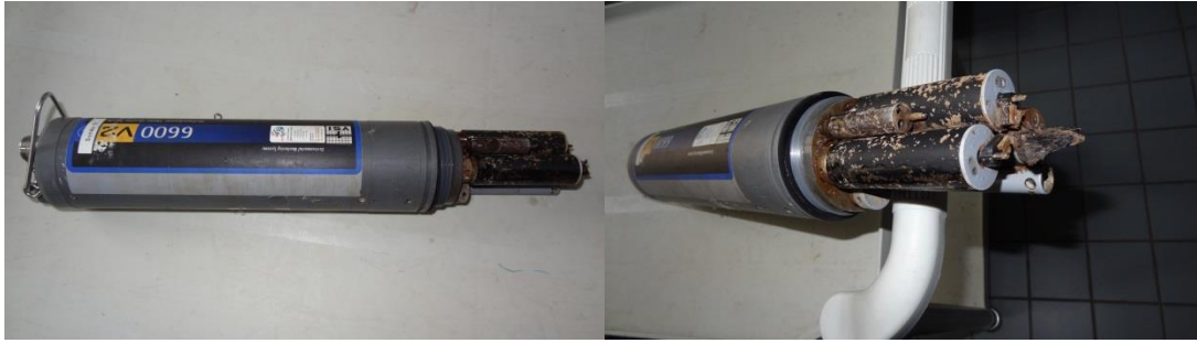
Abb. 3: Gesamtansicht und Sondenkopf der Multiparametersonde YSI 6600.
