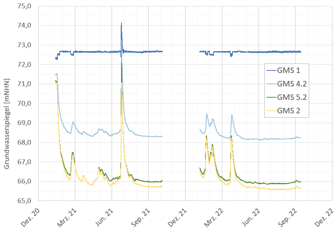
Abbildung 22: Grundwasserstandganglinien von GMS1, GMS4.2, GMS5.2 und GMS2. Deutlich ist der grundsätzlich identische Ganglinienverlauf bei GMS4.2, 5.2 und 2 erkennbar, welcher direkt vom Pegelstand im Unterwasser der Staustufe abhängig ist (vergleiche Abbildung 28/Abbildung 29). GMS2 weist dabei ein geringeres Druckpotential auf als die moselnäher gelegene GMS5.2 (zur Lage der GWM siehe Abbildung 7).
