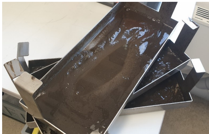
Abbildung 41: Der Schwebstoff wird in den Fallen in 3 Schalen gesammelt. Quelle: U. Köppe, BfG
