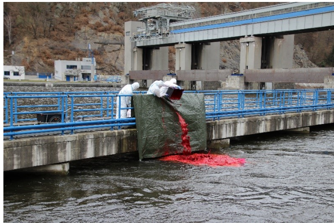
Abbildung 22: Einleitung des Tracers bei hohen Abflussbedingungen oberhalb des Wehres Vrané. Quelle: Povodí Vltavy
