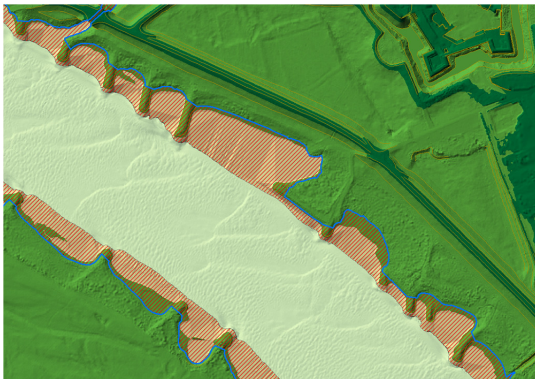
Abb. 3: Beispiel für Geländedaten der Elbe im Bereich Dömitz. Die Vorlanddaten stammen aus dem Landes-DGM aus MV, die Sohlhöhen aus der Flächenpeilung der WSV von 2017. Rot schraffiert ist der Bereich mit Daten aus dem DGM-W 2006.
