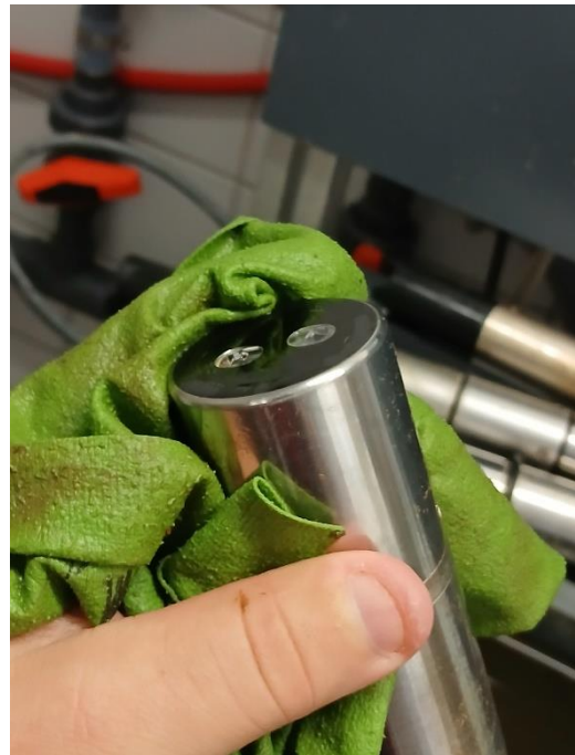
Abbildung 1: Reinigung einer Trübungssonde (Quelle: Alexander Zavorsky, BfG)
