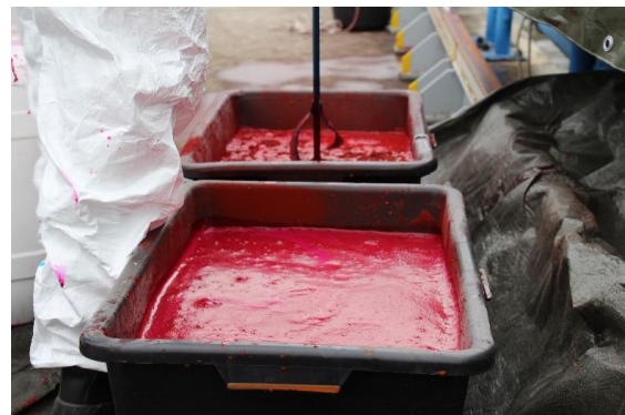
Abbildung 19: Anmischen des Tracerfarbstoffs vor einem Experiment zur Bestimmung des Stofftransports. (Quelle: Povodí Vltavy)
