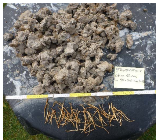
Schilf am Saale-Leipzig-Kanal und Durchwurzelung der Tondichtung, Schurf 1, 04./09.11.2020
