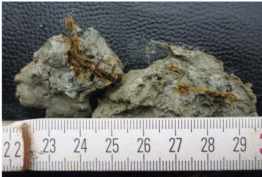
Abbildung 3-18: Abgestorbene Wurzel und durch Sauerstoffeintrag hervorgerufene Rostfleckigkeit. Der Wurzelkanal wurde für das Foto aufgeweitet.
