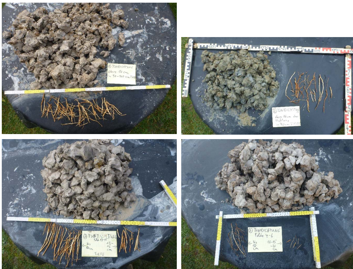
Abbildung 3-12: Tondichtungsmasse und darin enthaltene Wurzeln aus Schurf 1 (o. l.), Schurf 2 (o. r.) und aus zwei Teilproben des Schurf 3 (unten). In der unteren Bildreihe liegen die Wurzeln der oberen 10 cm Dichtung links der Karteikarte, die aus etwas tieferer Lage rechts davon.
