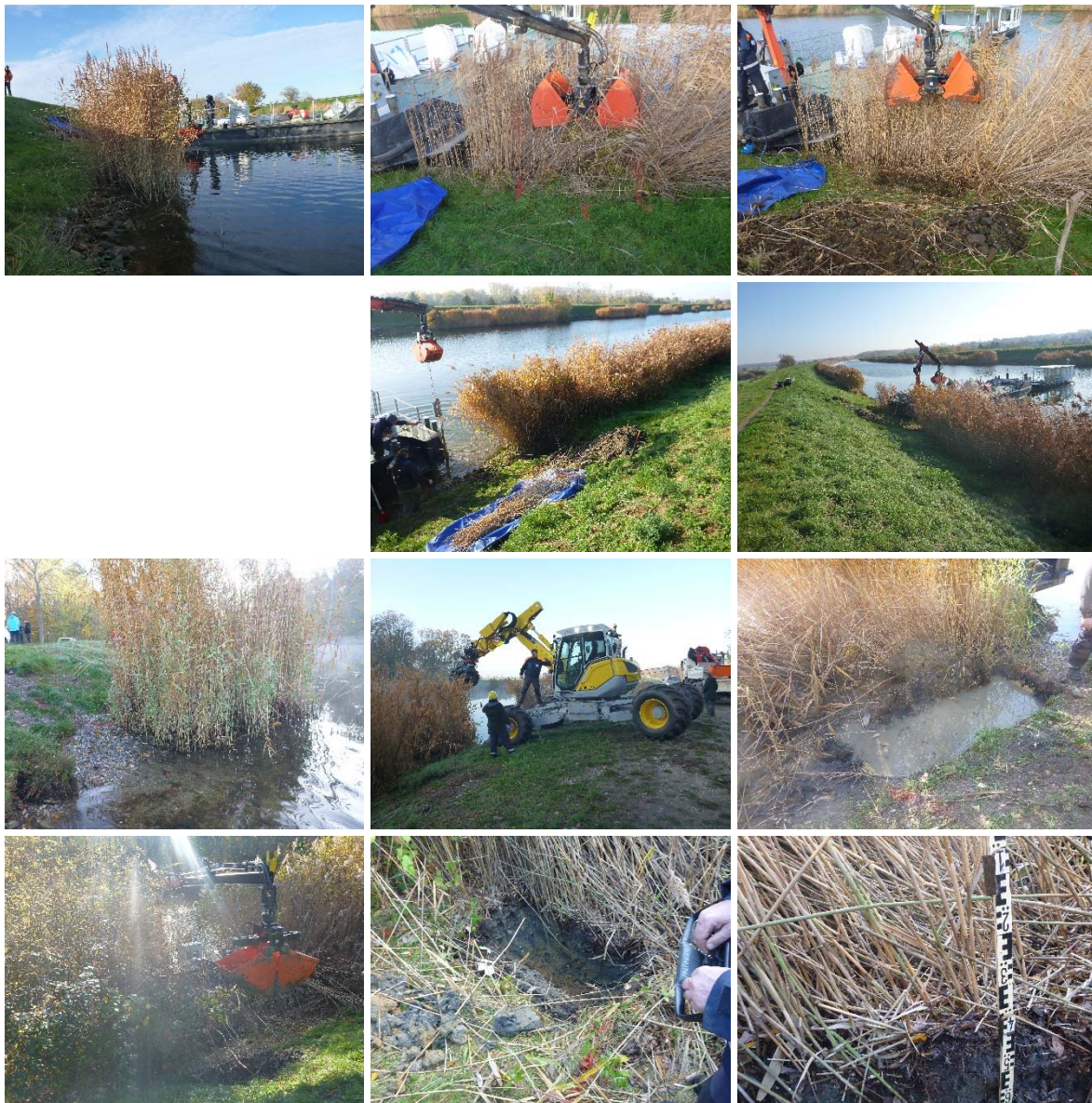
Abbildung 3-1: Untersuchte Schürfe (obere Reihe Schurf 1, zweite und dritte Reihe Schürfe 2 und 3, untere Reihe Schurf 4). Der Betriebswasserstand war um 20 cm abgesenkt.
