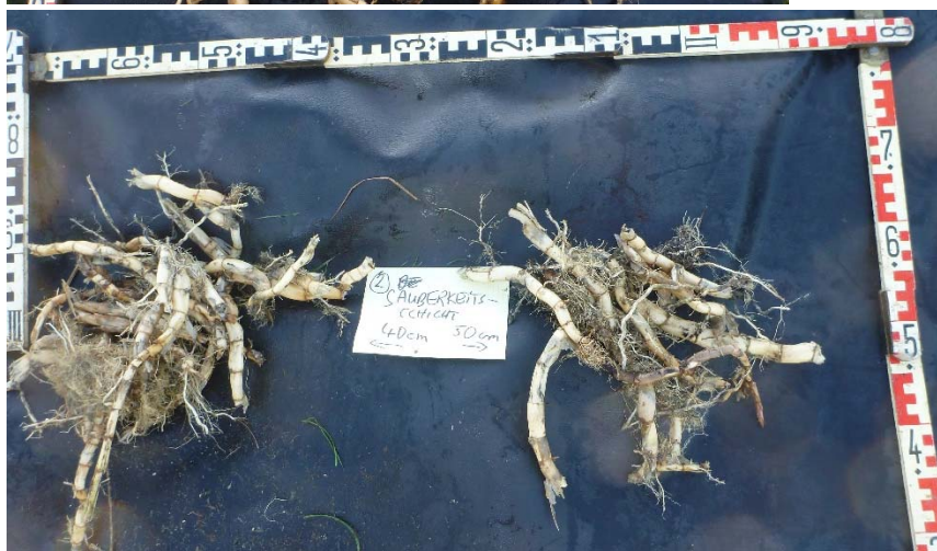
Abbildung 3-5: Schurf 2, Dölziger-Damm. Wurzelverhältnisse im Deckwerk in 20 cm Profiltiefe (oben) und in 40 und 50 cm Tiefe in der Sauberkeitsschicht (unten)
