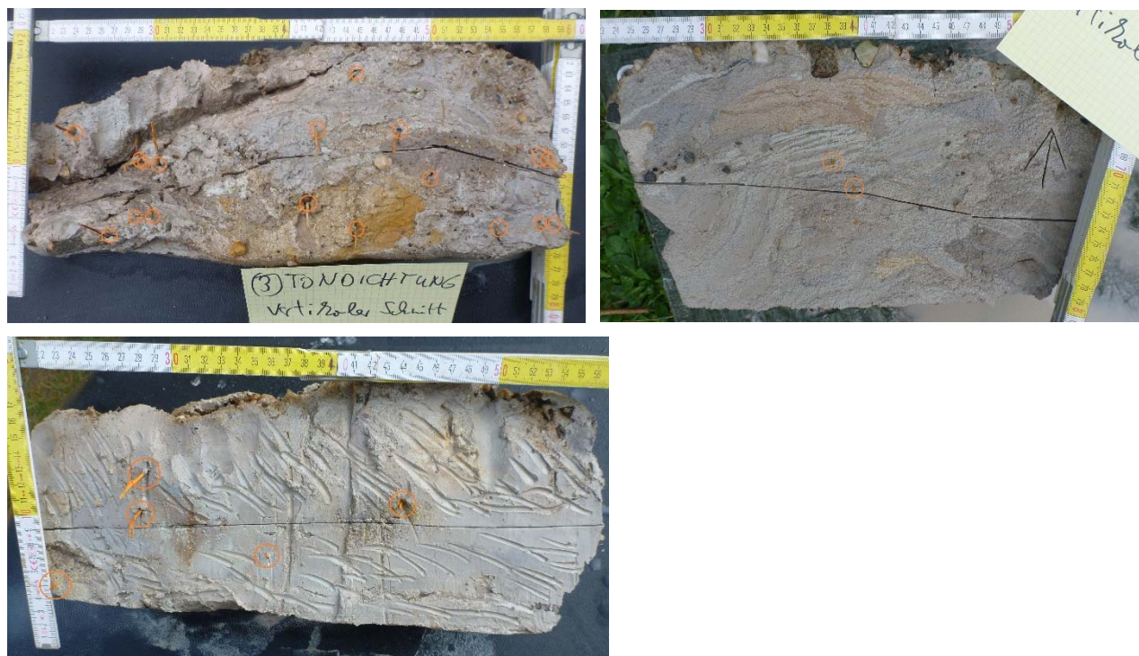
Abbildung 3-16: Vertikalschnitte durch die Dichtung. Die Oberkante der Dichtung ist oben auf den Fotos. Die dünne Linie ist die 10 cm-Dichtungstiefe. Die Vertikalschnitte wurden in den Felder 10-12 (o. l., Schnitt 1 in Tab. 3-3), 1-3 (o. r., Schnitt 2) und 16-18 (unten, Schnitt 3) durchgeführt. Zur Feldnummerierung siehe Abb. 3-14. Wurzeln sind markiert.
