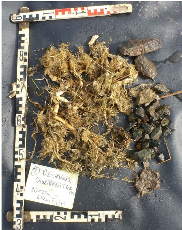
Abbildung 3-4: Schurf 1, Günthersdorfer-Damm. Wurzelverhältnisse und charakteristisches Substrat in verschiedenen Profiltiefen. Oben: Deckwerk in 25 (links) und 40 cm Profiltiefe (rechts). Unten links: Deckwerk an der Grenze zur Sauberkeitsschicht in 60 cm Tiefe. Unten rechts: Sauberkeitsschicht in 75 cm Profiltiefe.
