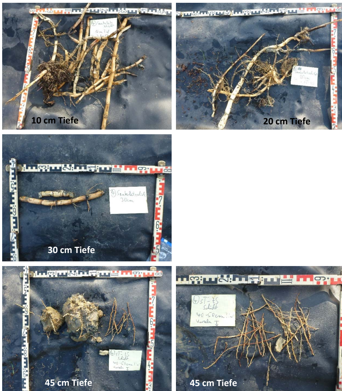
Abbildung 3-20: Wurzelssystem in verschiedenen Profiltiefen, Schurf 4, Bruchwiesendamm. In 45 cm Tiefe ist im Bild links das noch nicht vollständig ausgewaschene Substrat mit abgebildet, im Bild rechts ist die Gesamtwurzelmasse des Hols dargestellt.
