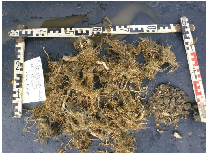
Abbildung 3-4: Schurf 1, Günthersdorfer-Damm. Wurzelverhältnisse und charakteristisches Substrat in verschiedenen Profiltiefen. Oben: Deckwerk in 25 (links) und 40 cm Profiltiefe (rechts). Unten links: Deckwerk an der Grenze zur Sauberkeitsschicht in 60 cm Tiefe. Unten rechts: Sauberkeitsschicht in 75 cm Profiltiefe.
