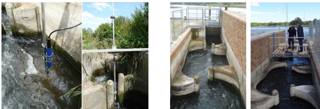
Abb. 3: Links: FAA Rothemühle, 3d-Strömungsmessung im Becken B4 und Schlitz S4, rechts: FAA Bahnitz 1d- und 3d-Strömungsmessung in Becken B3 (Fotos: TU Dresden, IWD)
