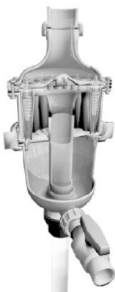
Abbildung 3.1: Schnittbild des Hydrozyklons ohne Filter (Waterco 2012)
